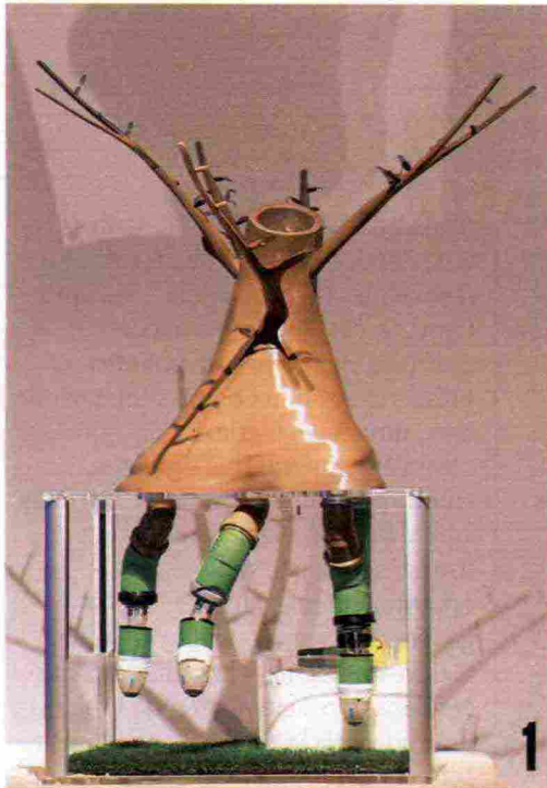
1. A sinistra, il plantoide messo a punto da Barbara Mazzolai, che simula le radici e penetra nel terreno. 2. Sensori collegate alle foglie per misurarne umidità e temperatura. 3. La mini-stampante in 3d dentro l'apice del robot (per «stampare» i rami).
